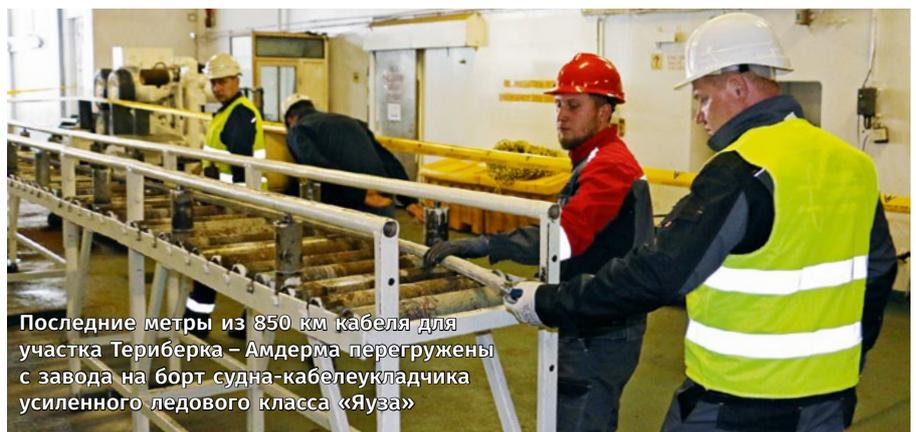
Последние метры из 850 км кабеля для участка Териберка – Амдерма перегружены с завода на борт судна-кабелеукладчика усиленного ледового класса «Яуза»
